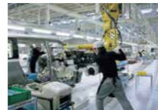
助力装置を使った重量部品の組み付け（組立）
