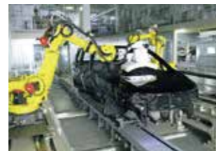
ロボットによる塗装面の品質チェック（塗装）
