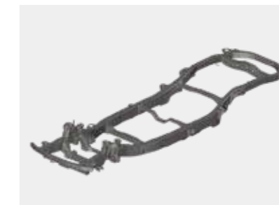
フレームの設計検討用CAE解析画像。新世代フレーム車など当社固有のものづくり技術をさらに深化
