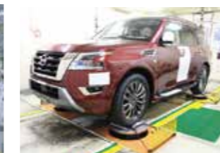
ファイナル検査工程の四輪加振機
