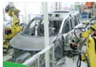
ロボットによるドアの自動組み付け工程（車体）
