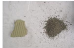
乾燥機による脱水汚泥の減量化
