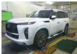
ファイナル検査工程の四輪加振機
