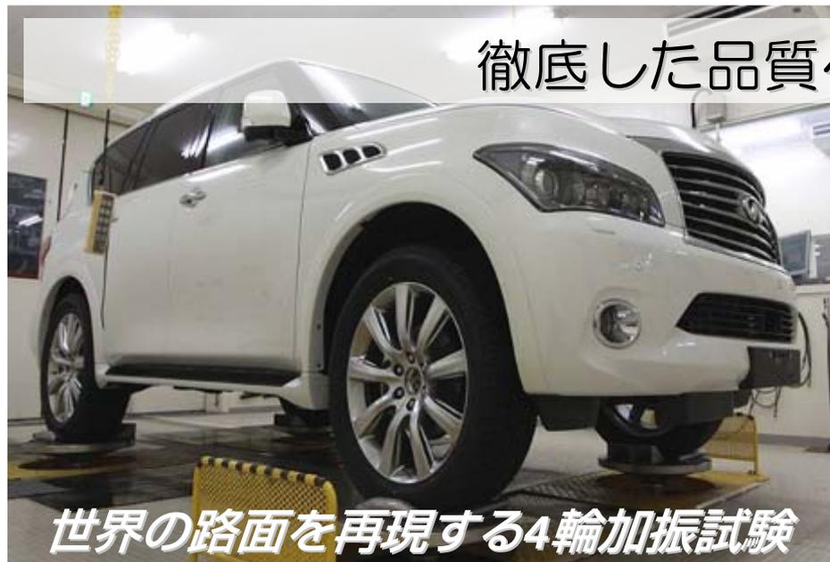
世界の路面を再現する4輪加振試験
