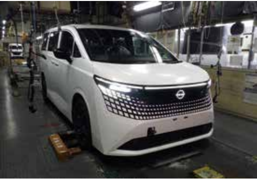
定置走行検査
