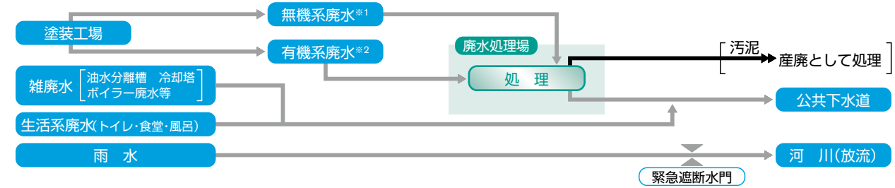
秦野事業所廃水処理フロー
