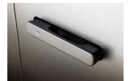
インテリジェントキーを持ってクルマに近づくと、ドアハンドルが自動的に出現する「フラッシュドアハンドル」を、INFINITIとして「QX80」に初搭載
