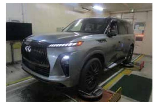
低級音加振検査
