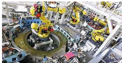
▶ローラーヘミングによるエンジン フードの生産
