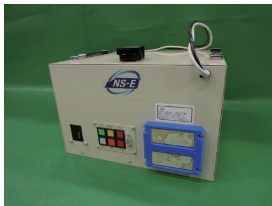
LB-BOX製作 (リチウムイオン電池 24V/48V用)
