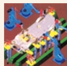
フロア組立シミュレーション
