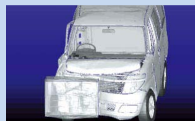
エルグランドのオフセット前面衝突シミュレーション。
