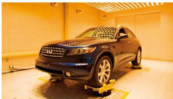
高低温車両加振室(-40℃~90℃)での実験
