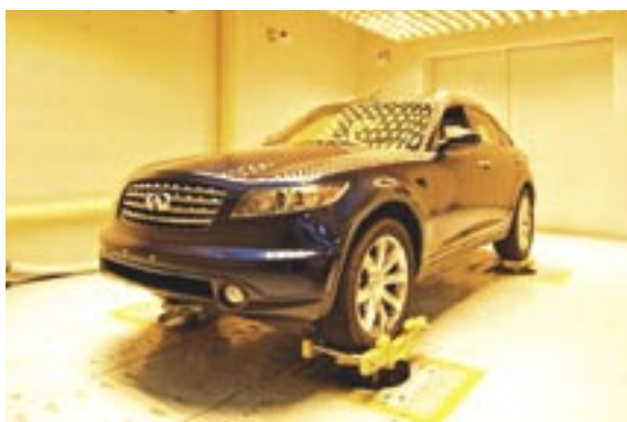
高低温車両加振室（-40℃～90℃）での実験
