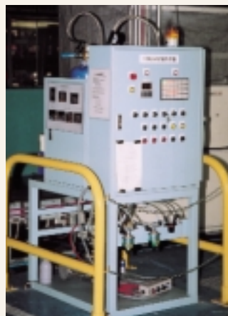
フロン回収装置（左）と ラインでのフロン充填作業（右）
