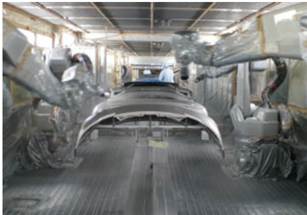
樹脂塗装ブース
