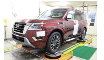
ファイナル検査工程の四輪加振機
