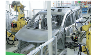
ロボットによるドアの自動組み付け工程(車体)
