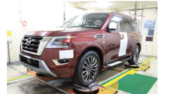
ファイナル検査工程の四輪加振機
