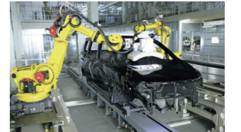
ロボットによる塗装面の品質チェック(塗装)
