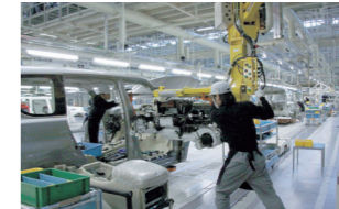
助力装置を使った重量部品の組み付け(組立)
