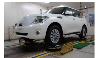
ファイナル検査工程の四輪加振機
