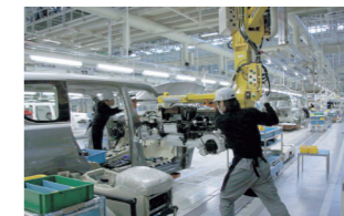
助力装置を使った重量部品の組み付け(組立)
