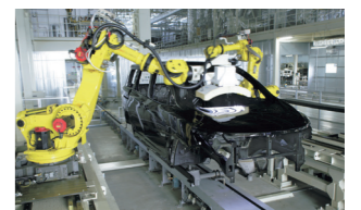
ロボットによる塗装面の品質チェック(塗装)
