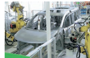
ロボットによるドアの自動組み付け工程(車体)
