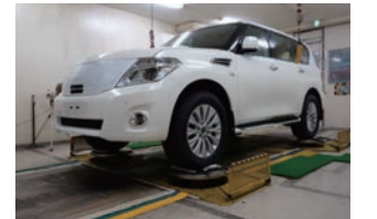
ファイナル検査工程の四輪加振機
